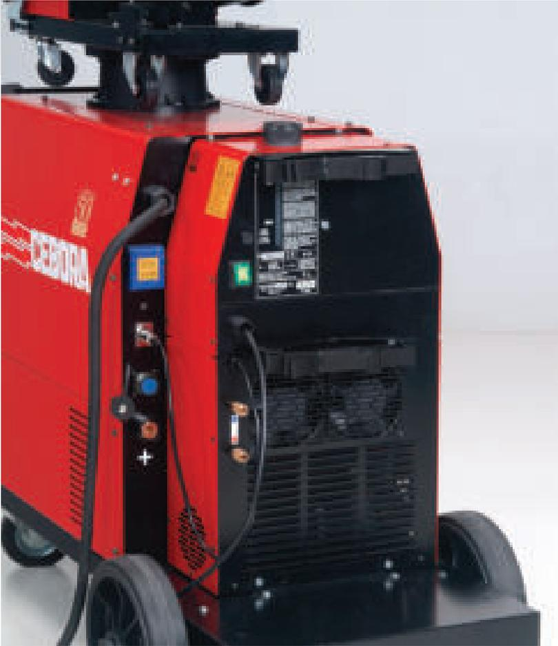
Las máquinas EVO SYNERGIC Art. 643 y 647 pueden ser utilizadas con antorchas MIG enfriadas por aire. Para usos más pesados es posible instalar en la máquina la unidad de enfriamiento modular opcional (Art. 1680), la que permite utilizar antorchas MIG enfriadas por agua.
